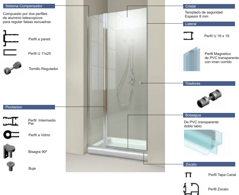
Despiece para modelos con Pivotacion a Vidrio
